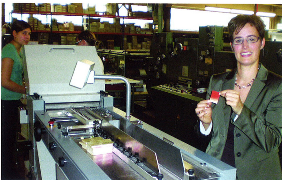
Auf der neuen Falzmaschine Multimaster CAS 38 können auch Produkte mit einem Endformat von nur 35 x 40 mm gefalzt werden.
