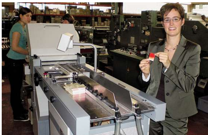
Auf der neuen Falzmaschine multimaster CAS 38 können auch Produkte mit einem Endformat von nur 35 x 40 mm problemlos gefalzt werden.
