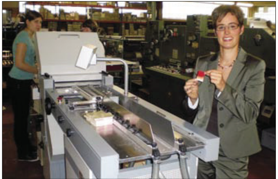
Auf der neuen Falzmaschine multimaster CAS 38 können auch Produkte mit einem Endformat von nur 35 x 40 mm problemlos gefalzt werden, wie Anne Kappes, Geschäftsführung AWD Druck, demonstriert.
