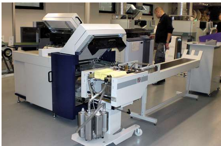
Effiziente Produktion durch Online-Anbindung: Die vollautomatische Falzmaschine prestigeFold Net 52 ist direkt an die Océ 7550 angebunden.
