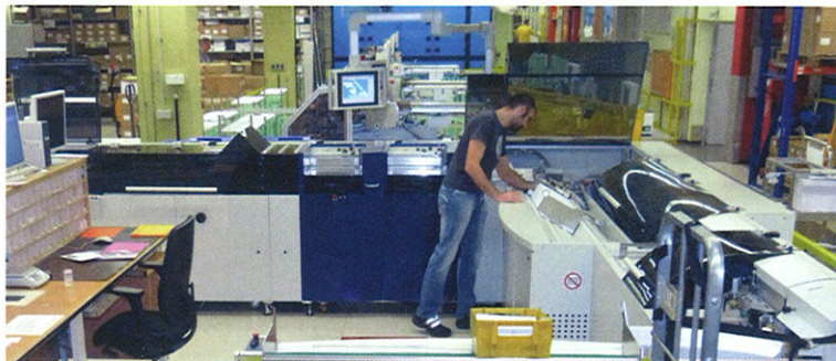
Bei Datev mit Sitz in Nürnberg ersetzen jetzt zwei Autoset 18 von MB Bäuerele die drei früheren Kuvertiersysteme.
