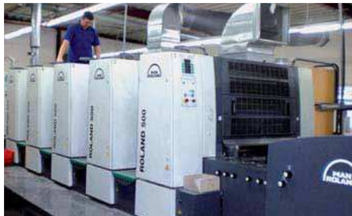
Fünffarben-Bogenoffsetmaschine Manroland 500 mit zusätzlichem Lackwerk, das bei Figge für ganzflächigen Schutzlack oder partielle Lackierungen eingesetzt wird.
