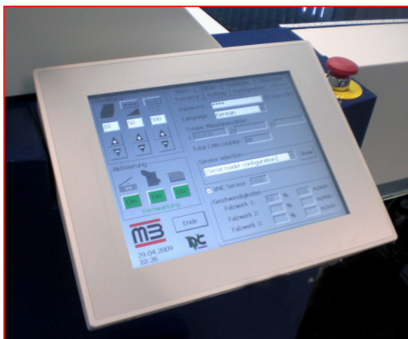
Touch-Screen-Display mit aktiviertem Fernwartungsmodus der vollautomatischen Falzmaschine prestigeFOLD NET 38.
