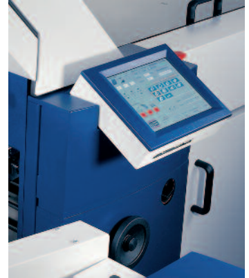
Die Falzmaschine prestigeFold Net von MB Bäuерle ist mit einem Touch-Screen-Display ausgerüstet.
