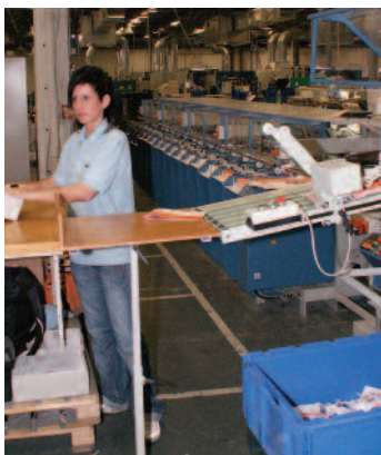
Broschürenfertigung mit zwei MKW- und einer Theisen & Bonitz-Anlage mit Heft-, Falz- und Schneidaggregat.
