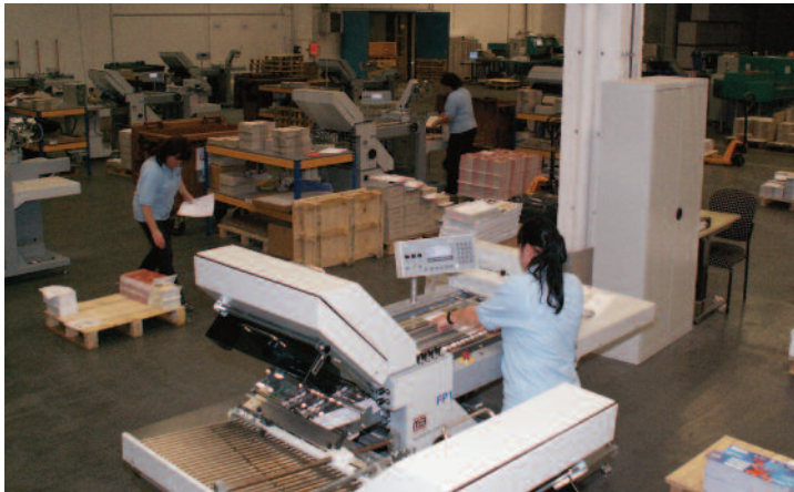
Elf Falzmaschinen der MB Bäuerle GmbH mit Einlaufbreiten von 38 und 52 cm sind wegen der sicheren Produktionsweise und des Handlings via Touchscreen wichtige Produktionsmittel in der Druckweiterverarbeitung.
