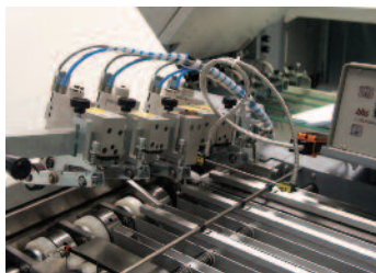
Das Taktkopfmodul lässt sich komplett auswechseln.
