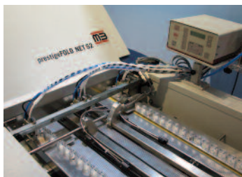
Kaltleimsystem mit Steuergerät für Falzklebung.
