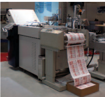
Konfiguration PrestigeFold Net 52 zur Herstellung eines Selfmailers im Doppelnutzen vom Endlosstapel.
