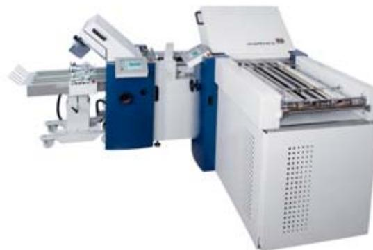
Das Kreuzbruchfalzsystem prestigeFOLD NET 52 mit Doppelausrichttisch DAT 24 ermöglicht ein- oder zweibahnige Produktion.
