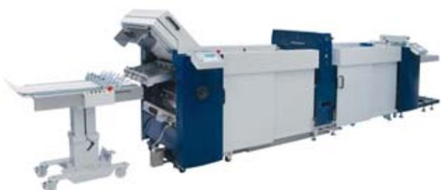
Die Komponenten des Multiflexiblen Inline-Systems sind auf Schienen montiert, so dass diese je nach Einsatzzweck passend positioniert werden können.
