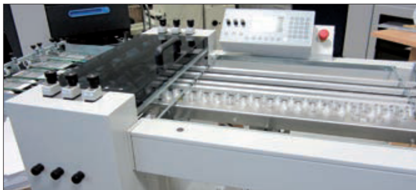
Das Schneidmodul verfügt über drei Wellenpaare für Schneid-, Perforier- sowie Rillwerkzeuge.
