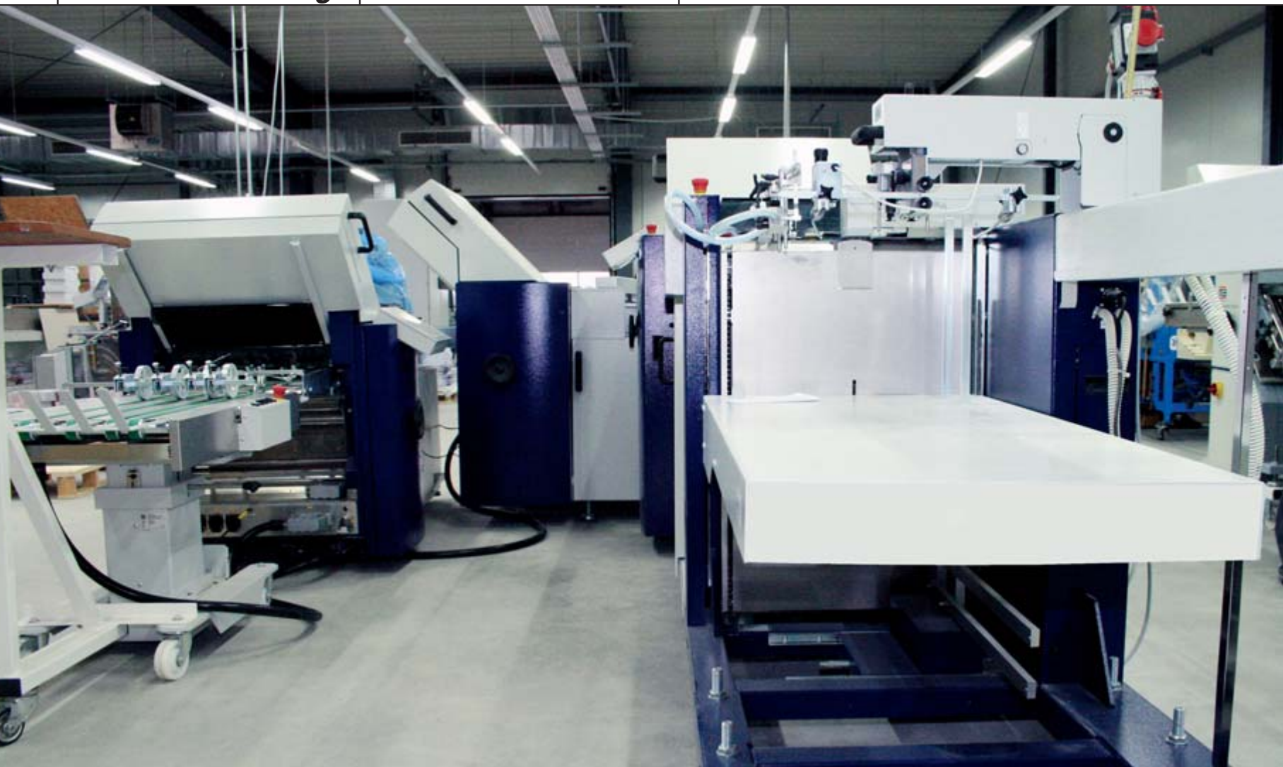
Der Flachstapelanleger FSA kann auch Bogen mit einer Länge von bis zu 130 cm verarbeiten.
