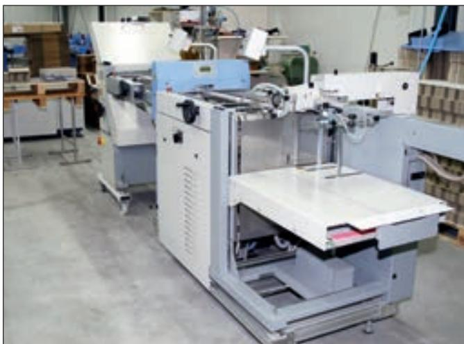
**Das vorhandene Falzsystem multimaster CAS 52 wurde um ein Balkenrillsystem sowie einen Flachstapelanleger mit Ausrichtstrecke ergänzt.**
