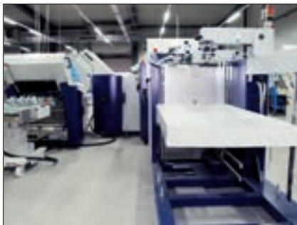
**Der Flachstapelanleger FSA kann auch Bogen mit einer Länge von bis zu 130 cm verarbeiten.**
