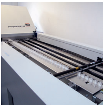
Der Ausrichttisch ART 52 des Falzsystems ist speziell für die Übernahme der Bogen aus dem Ricoh-Digitaldrucksystem konzipiert.
