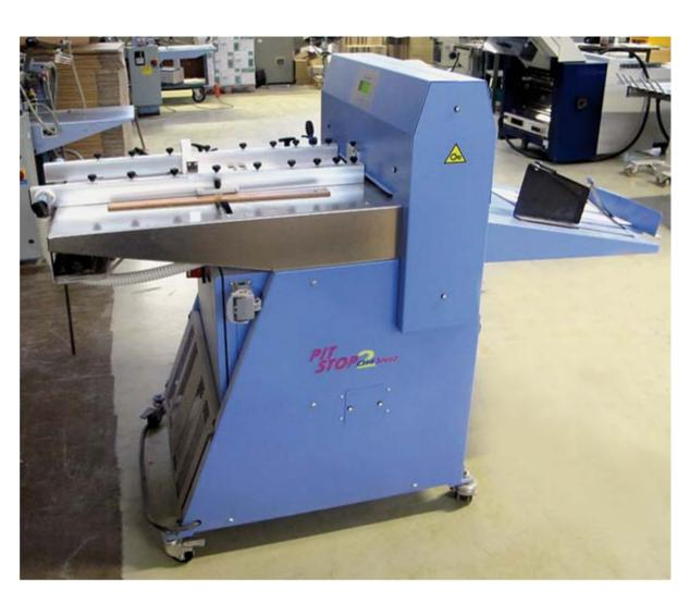
Das neue Balkenrillsystem Pit Stop DH Speed zeichnet sich durch seine vielfältigen Produktionsmöglichkeiten
