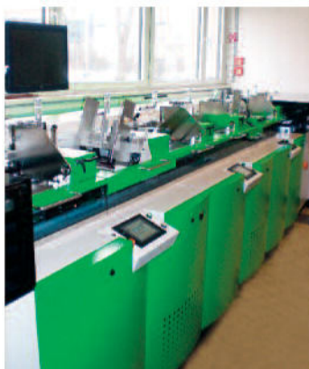
Das bereits vorhandene grüne Kuvertiersystem autoSet B4 verfügt über sechs Beilagenstation mit unterschiedlichen Beilagenanlegern.
