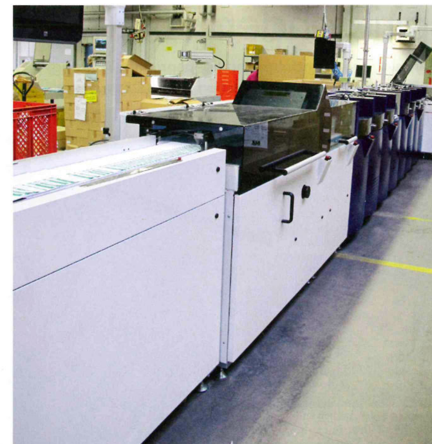
Das Kuvertiersystem kann bei Drescher mit Einzelblatt- oder Rollenware beschickt werden.
