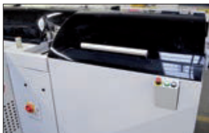
Die autoSET 18 verfügt bei Drescher am Ausgang über ein Kuvertwende-modul.
