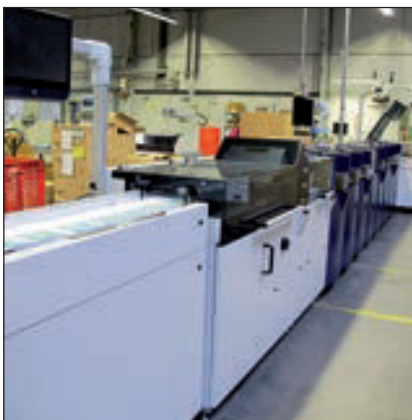
Das Kuvertiersystem kann bei Drescher entweder mit Einzelblattware oder Endlosmaterial von der Rolle beschickt werden.
