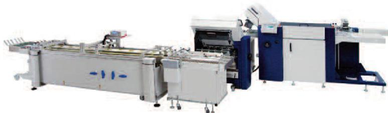
*Vakuumband mit Heißleimventil und Pflugfalz inline integriert nach der Falzmaschine prestigeFold Net 52 von MB Bäuerte.*
