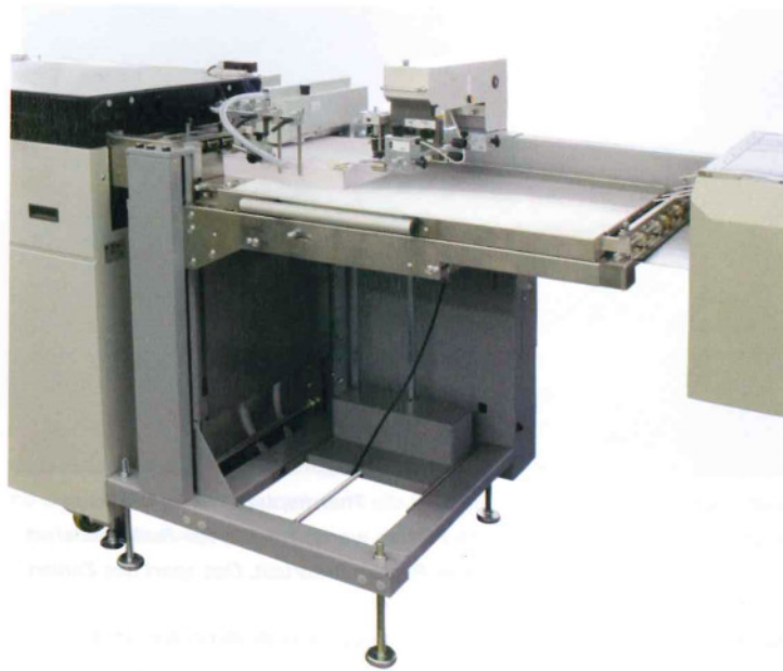
Der Flachstapelanleger FSA 52-Online ermöglicht die Zuführung von Einzelblattware ...
