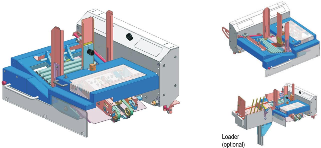
Vielseitige Einsatzmöglichkeiten bei unterschiedlichen Anforderungen sind die Stärke unserer Anleger. Schnelles und sicheres Zuführen sind stets garantiert. Durch den Einsatz der passenden Technologie wird gewährleistet, dass ein sehr breites Material- und Formatspektrum verarbeitet werden kann.
